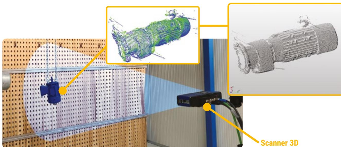
**Image MATCH 3D PRO** riconosce l'inclinazione e la posizione dei pezzi ed **adeguа il percorso di verniciatura in automatico**
